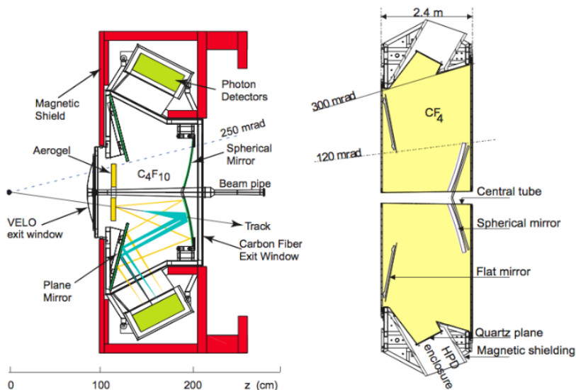
Figura 3.15: Representación esquemática de los subdetectores (izquierda) RICH-1 y (derecha) RICH-2
